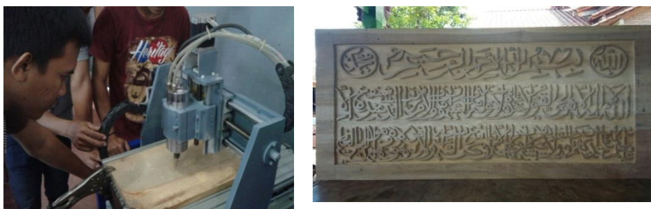
Gambar 3.1 Proses mesin bubut ukir kayu CNC untuk kaligrafi ukir kayu dengan dimensi 30 x 35 x 6 mm.
