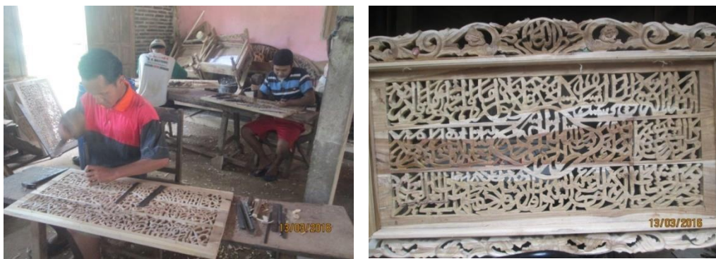
Gambar 1. Kondisi proses ukir kayu konvensional untuk pembuatan kaligrafi kayu di Kelompok Usaha di Desa Sangkanayu
