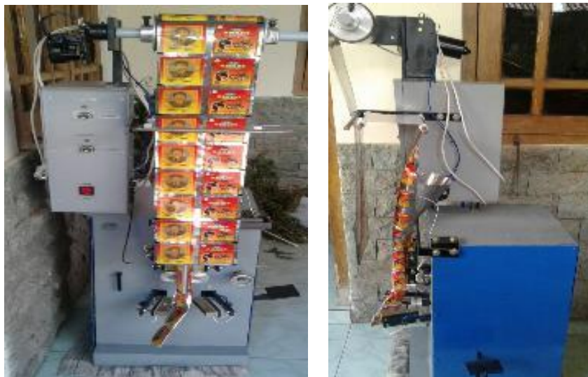
Gambar 3.4. Mesin sachet dengan dilengkapi mekanik pemanasan, pemutaran dan pemotongan feeder ke filler [8]
