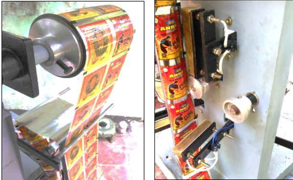
Gambar 3.5. Cara kerja mesin sachet pada paking plastic/aluminium foil
