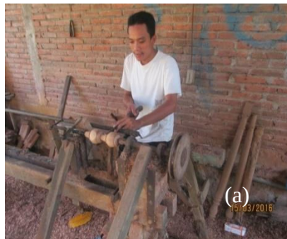
Gambar 1. a) Proses bubut kayu konvensional untuk membuat kepala sangkar, b) model sangkar burung
