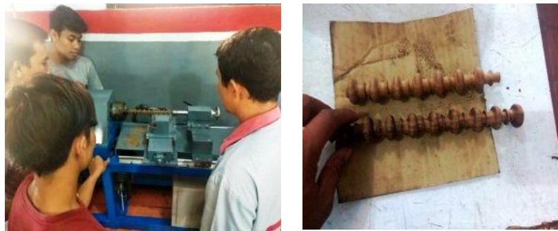
Gambar 3.1 Proses mesin bubut kayu CNC untuk kaki sangkar burung
