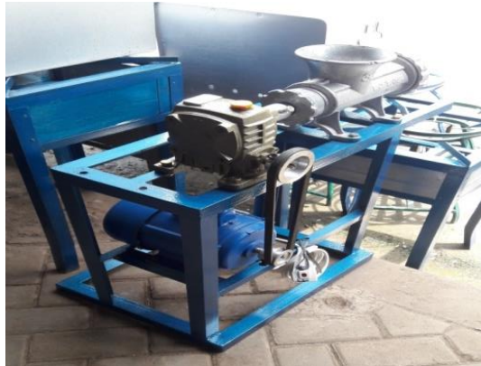
Gambar 3. Mesin Penggiling Daging Kapasitas 100 kg/jam
