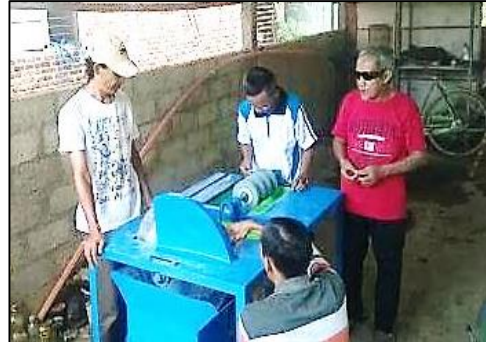
Gambar 5. Pengenalan bagian-bagian mesin potong dan poles batu akik
