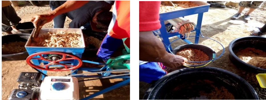
Gambar 3.4. Pembuatan pellet lele dengan mesin kombinasi
