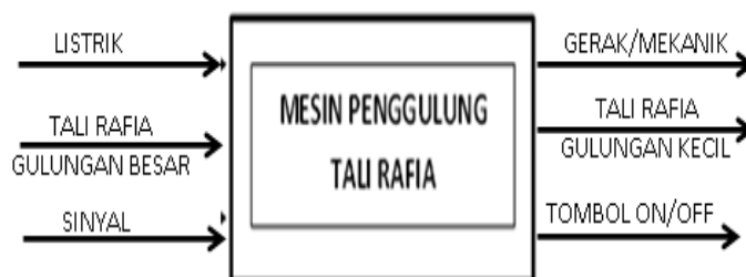
Gambar 2.1 Diagram blok fungsi mesin penggulung tali rafia
