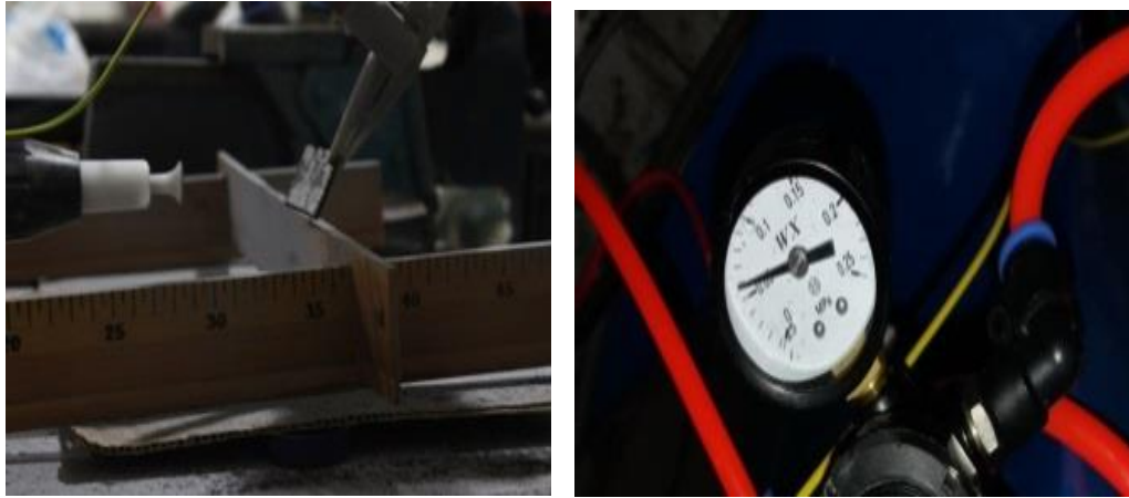
Gambar 2.4 jarak nozzle dan tekanan udara
