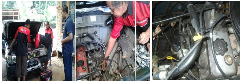
Gambar 11. (a) pengecekan selang plastik, (b) sambungan dan pipa katalis, c) Kran pengatur aliran uap hidrokarbon
