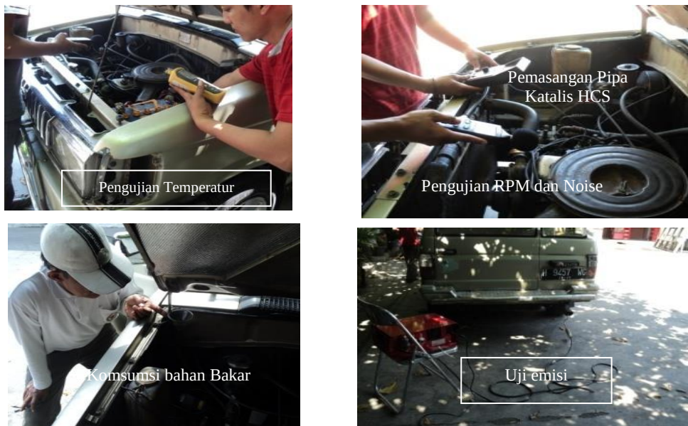
Gambar 12. Pengujian performa mesin setelah dipasang penghemat bahan bakar
