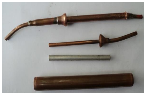
Gambar 7. Penyettingan pipa tembaga sebelum dilas
