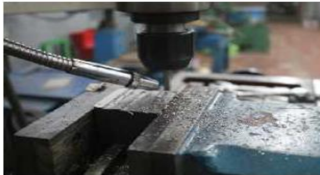
Proses pemberian pendingin saat pengefraisan
