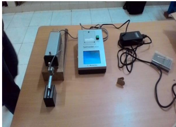
Gambar 2.2 Alat Pengambilan Data Kekasaran permukaan benda kerja
