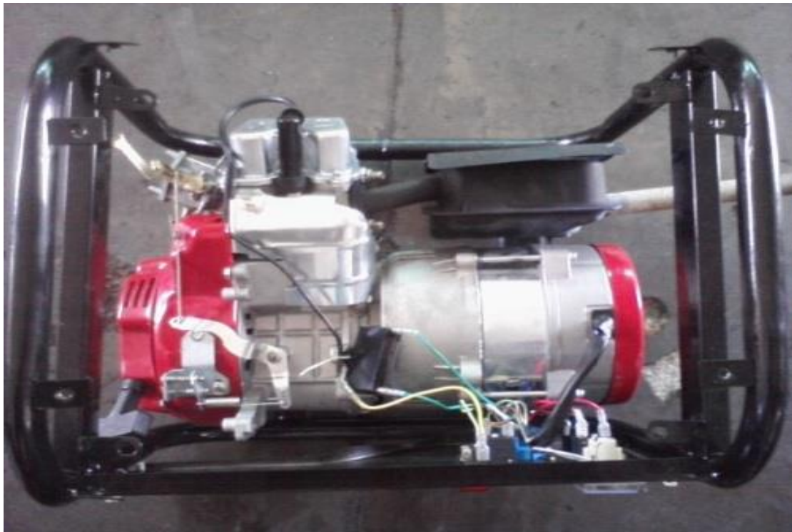
Gambar 2.4. Motor Bensin Stasioner type ET 3900 LE,
