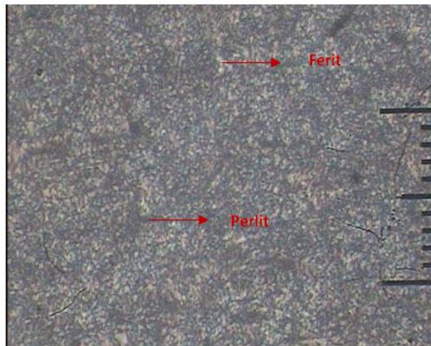
Gambar 9. Foto mikro media pendingin Oli SAE-40
