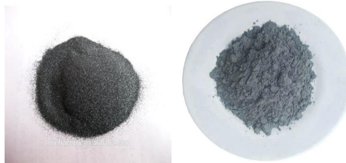
Gambar 2. Serbuk Silicon carbida untuk pelapis thermal spray coating, [9]
