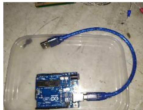
b. Kabel koneksi untuk pemrograman
