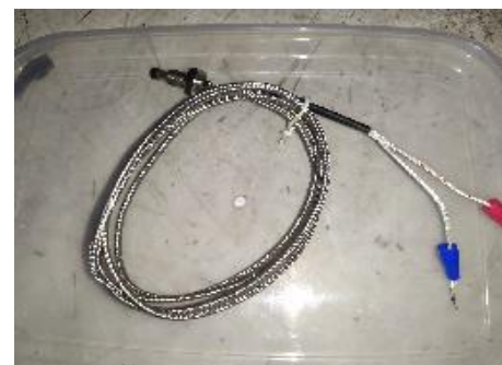
d. Kabel sensor suhu untuk input ECU/ARDUINO
