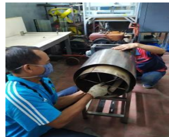
b. Pemasangan tabung rotary pada tabung housing roaster
