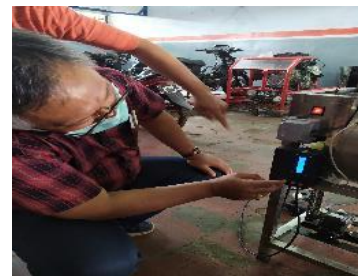
b. Set up suhu proses untuk alarm
