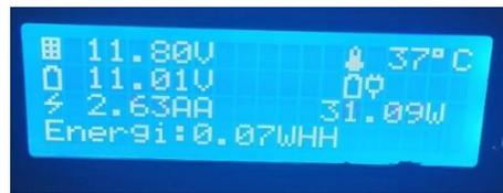
**Gambar 6** Tampilan monitoring pengukuran daya dan hasil pengukuran sensor-sensor
