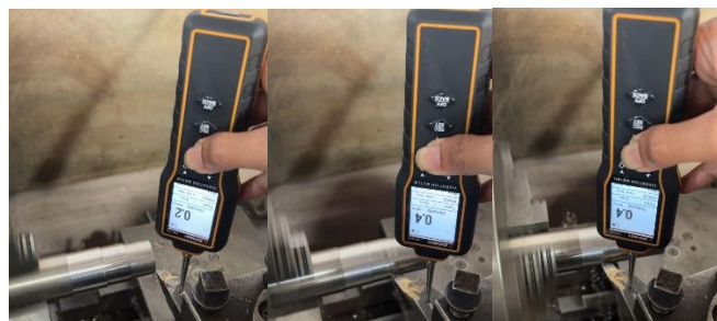
Gambar 3. Pembubutan ketebalan 1 mm, 0.5 mm dan 0.2 mm
