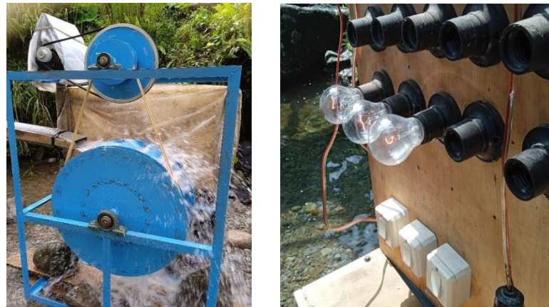
Gambar 5. Pengujian Turbin Crossflow
