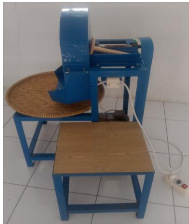
Gambar 4. Alat Pemotong Tempe Baru
