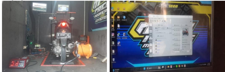
Gambar 1. Proses kalibrasi pada dynotest dan emission gas analyzer .
