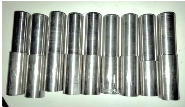
Gambar 1. Hasil pembubutan specimen baja SS316L
