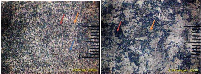
Gambar 4. Struktur mikro bagian tepi (kiri) dan bagian tengah (kanan)
