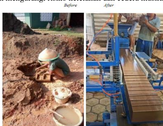
Gambar 7. Mesin pembuat batu bata (Sumber: Berkah Teknik Banjarnegara)
