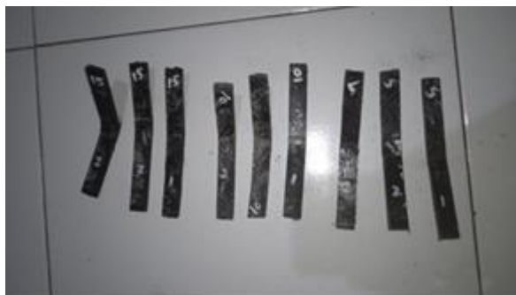
Gambar 4 Spesimen hasil uji lentur dengan variasi karbon aktif 5%,10% dan 15%
