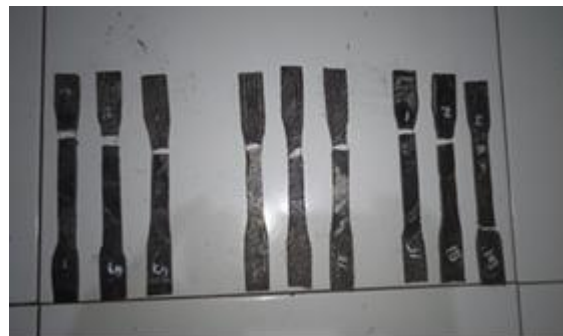
Gambar 3 Spesimen hasil uji tarik dengan variasi karbon aktif 5%,10% dan 15%
